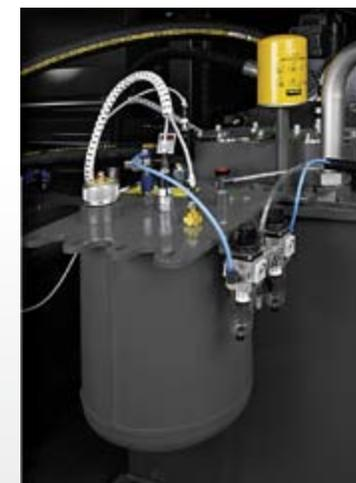
**Réservoir d'huile de lubrification** pour l'équipement de pulvérisation anti-étamage.
