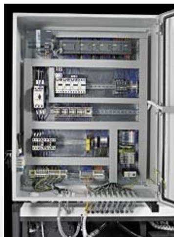
L'**Armoire électrique** est conforme à la norme EN 60204-1 et contient des composants électriques et électroniques contrôlant la presse à briquettes.
