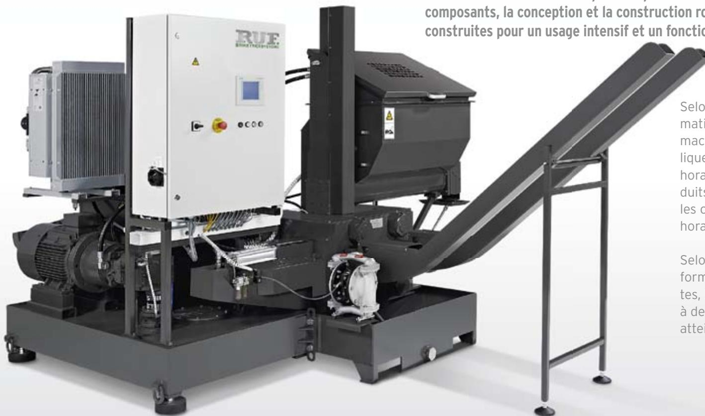
Selon les équipements annexes et la matière à traiter, nous fabriquons des machines équipées de moteurs hydrauliques de 3 kW à 90 kW avec des débits horaires de 30 à 1.500 kg pour des produits organiques tels que le bois. Pour les co-produits métalliques, les débits horaires peuvent atteindre 4.800 kg.
