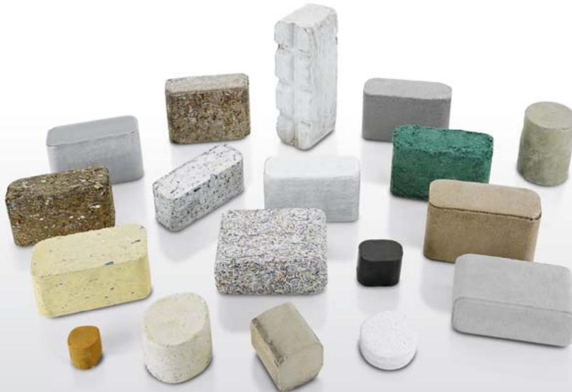
La sécurité est un facteur important dans de nombreux procédés de recyclage. Lors de l'élimination de billets de banque, les banques utilisent après déchiquetage des billets des systèmes de briquetage pour exclure tout risque de «réutilisation».
