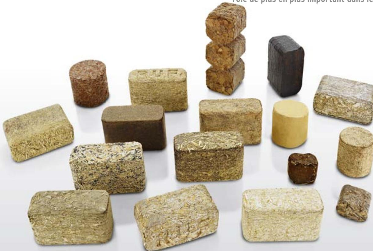
La plupart des matières organiques peuvent être transformées par les équipements de compactage RUF en briquettes compactes, 100% naturelles, et possédant un excellent pouvoir calorifique. La vente de briquettes à des particuliers est également une source de revenus complémentaires lucrative. L'environnement et les entreprises en retirent des bénéfices à égale mesure. Le briquetage des poussières réduit non seulement le risque d'explosion mais simplifie considérablement la logistique.
