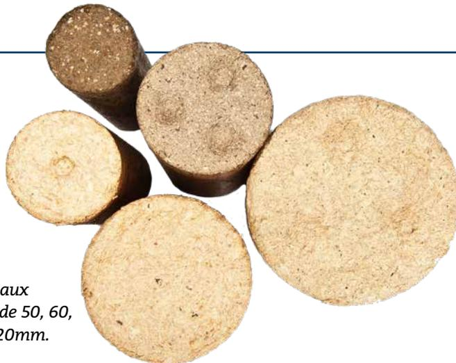
*Briquettes aux diamètres de 50, 60, 75, 90 et 120mm.*
