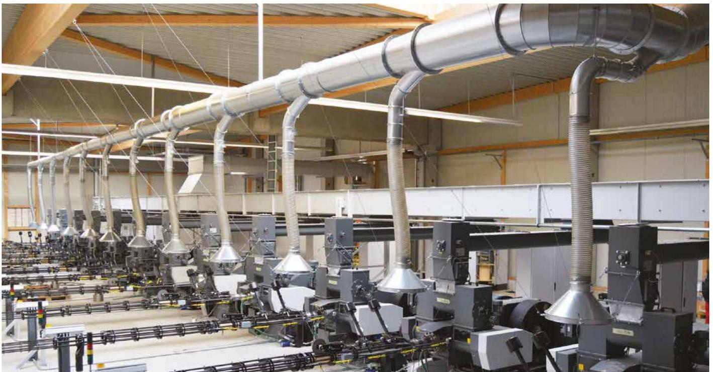
*L'image montre ce qui est probablement la plus grosse ligne de production de briquettes destinées aux particuliers au monde, d'une capacité de plus de 100.00 tonnes par an. 12 presses à briquettes BP 6500 HD, découpeuses et trieuses pondérales.*
