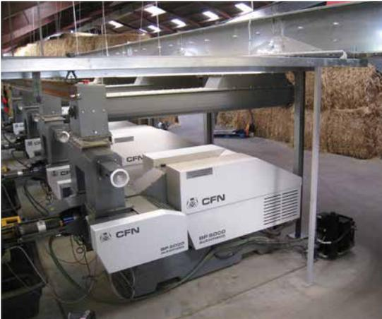
4 presses BP6000 produisant des briquettes de paille de blé pour la litière, d'une capacité de 6 t/h.
