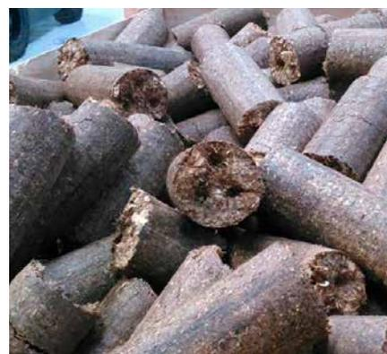
Au Kenya nous avons installé une solution complète avec un grand broyeur à marteau et 4 presses à briquettes BP6510 d'une capacité de 6 t/h. Les briquettes seront utilisées comme combustible, en remplacement du bois de chauffage.
