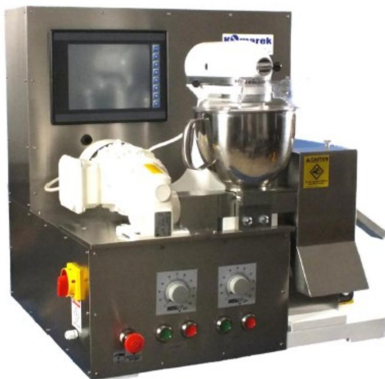
La presse à roues tangentes B050, modèle le plus petit actuellement sur le marché, a été spécialement conçue pour des applications de recherche et de laboratoire de faible capacité.
